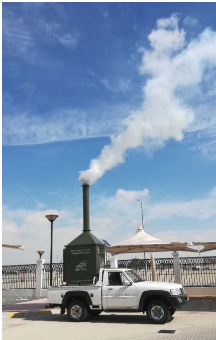
图2 阿联酋引进中国地面燃烧炉设备开展暖云催化增雨试验（阿布扎比，2019年3月）
