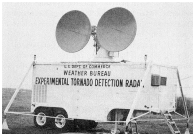
图1 20世纪50年代末USWB使用的连续波3 cm多普勒雷达，设计了并排的发射和接收天线
