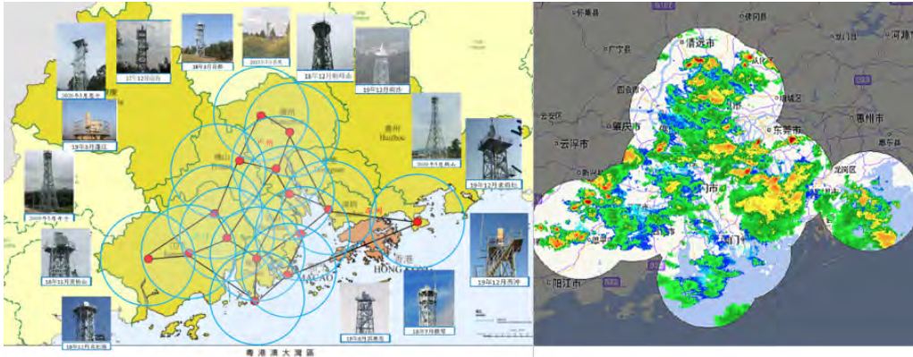
图8 广东大湾区X波段双极化相控阵雷达精细化探测网
