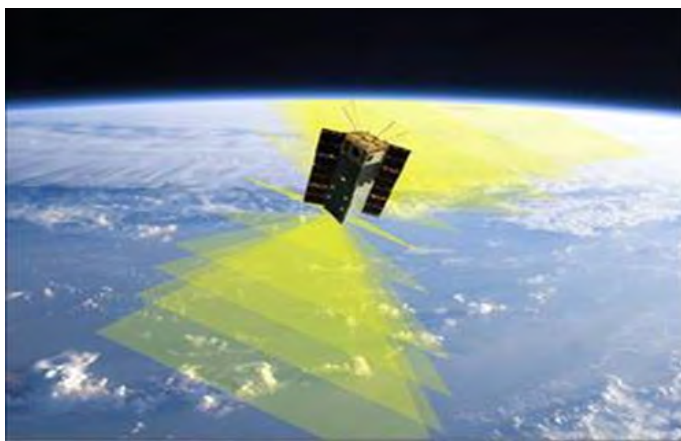
图3 CSLI项目第100个3U-CubeSat-HARP，于2019年11月2日发射，旨在测量大气气溶胶、云水和冰粒的微物理特性（来自NASA网站）
