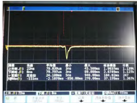
图6 D25芯片3脚输出其中一个周期内示波正常图形 Fig. 6 One wave normal figure of D25 chip 3 pin output
