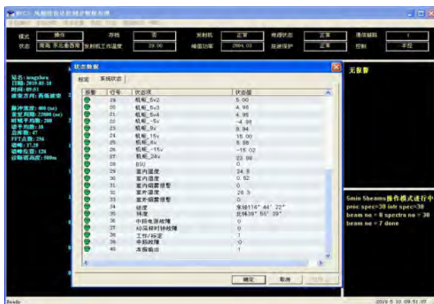
图6 WPCS软件读取ZigBee无线传感器网络的数据
