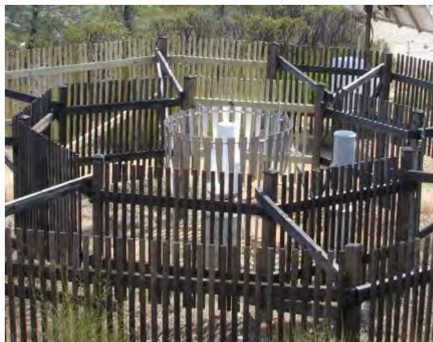
图4 装有防风罩的称重式雨量计 (图中白色物体为雨量计) (USA/NCDC: http://www.ncdc.noaa.gov/crn/ )
