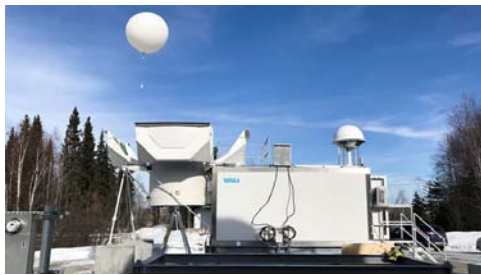
机器人在美国阿拉斯加完成全自动探空气球观测，按照常规测站需求，自动化探空气球施放机器需要每12天装载一次
