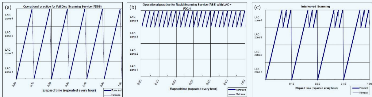
图2 欧洲MTG卫星成像仪观测模式 Fig. 2 Observation mode of MTG Imager
