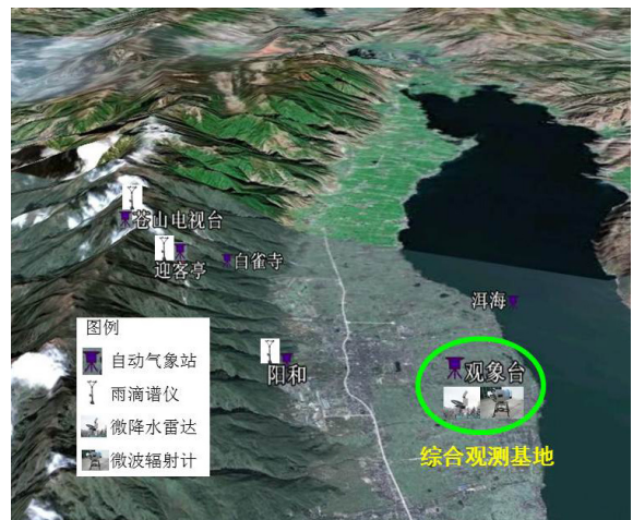
图2 云南大理观测区多种遥感设备布局
