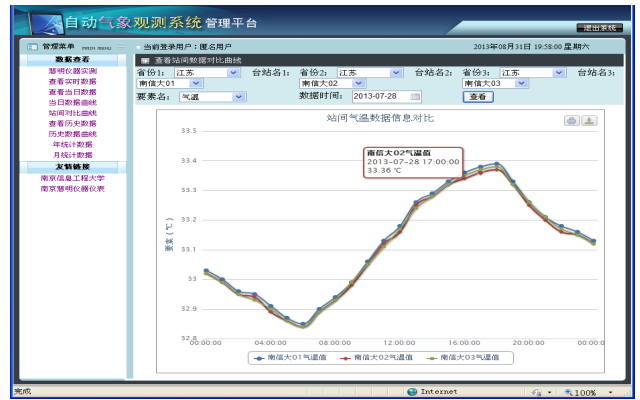
图8 三传感器气温日变化的对比观测
